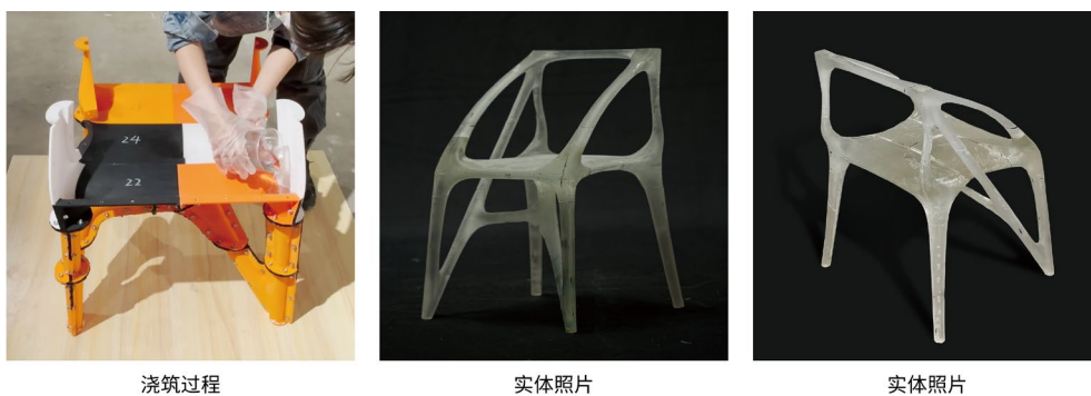
图 11 浇筑过程与仿生学椅实体照片（图片来源：作者自绘）
