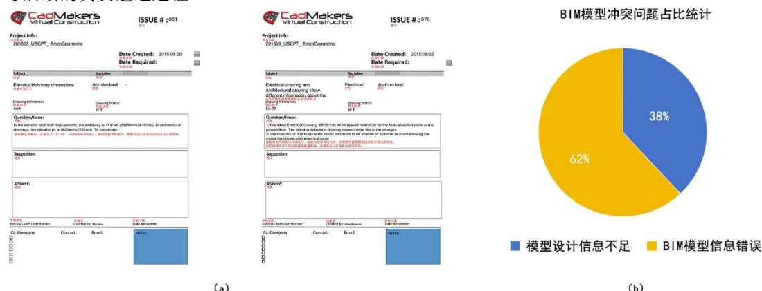
图 6 (a) 项目设计协同过程中产生的碰撞检测报告；(b) BIM 模型中各类冲突问题占比 (图片来源：a UBC BIM TOPiCS Lab 提供，b 作者自绘)
