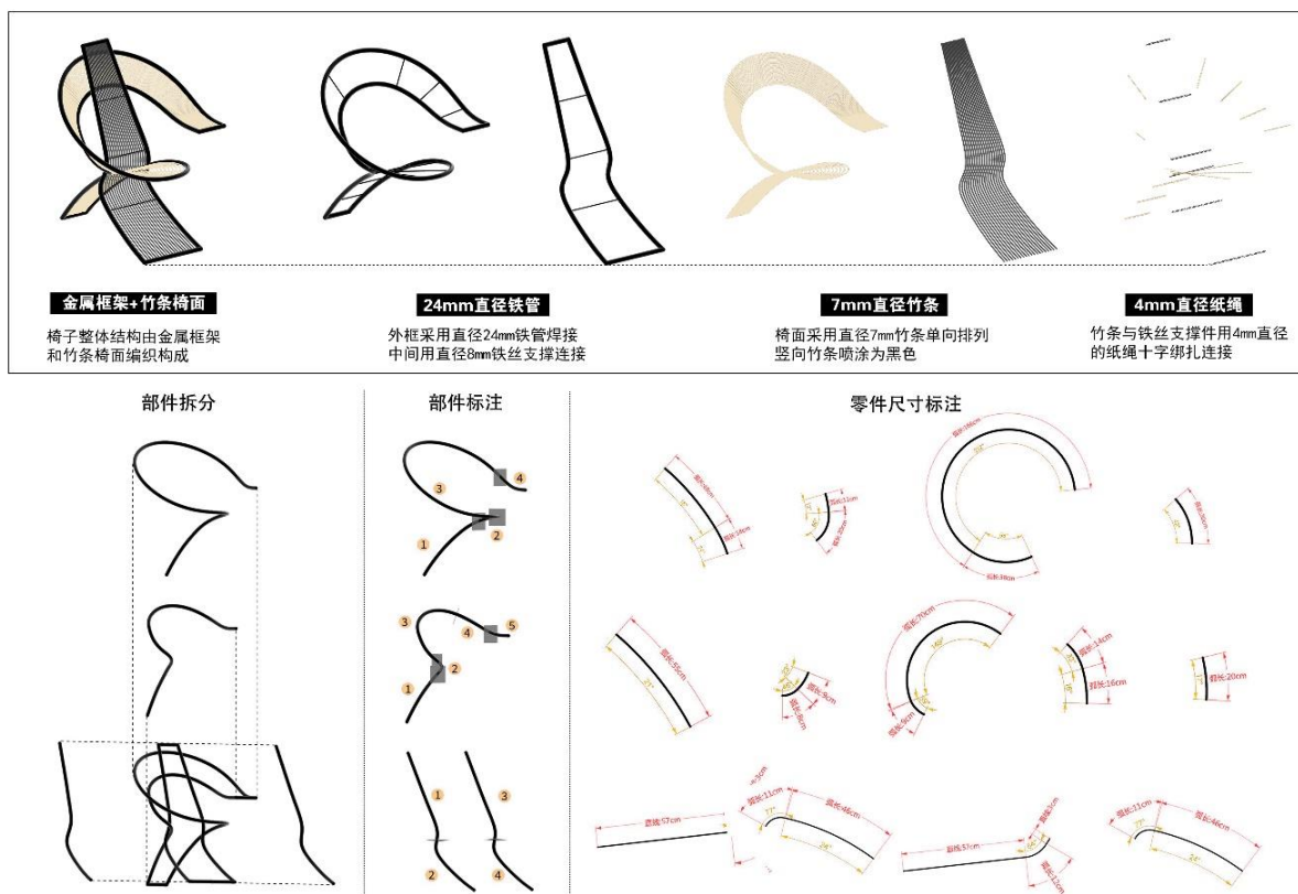
图 4 建造工艺及金属框架加工图纸（图片来源：作者自绘）
