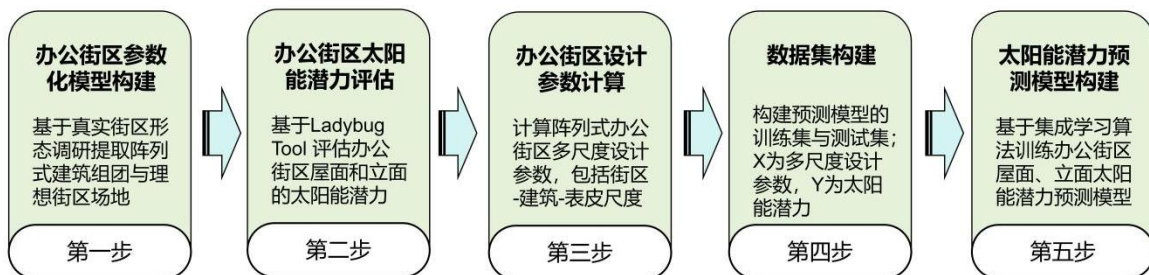
图1 基于集成学习算法的阵列式办公街区太阳能潜力预测模型构建流程（图片来源：作者自绘）
